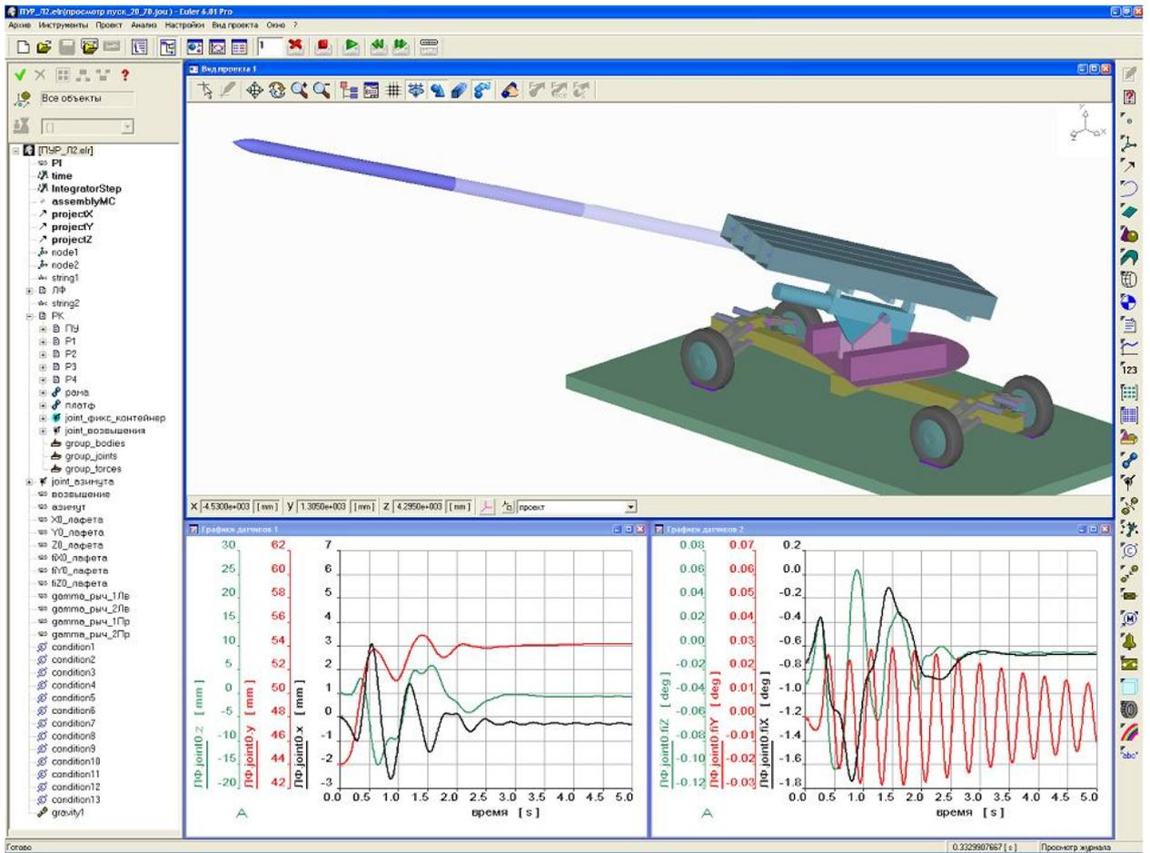
Рис. 3. Внешний вид экрана программного комплекса EULER
